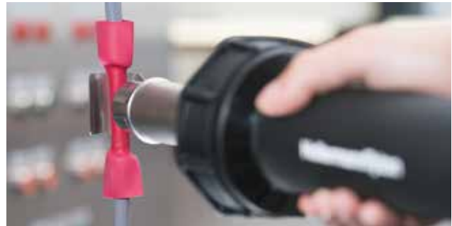
Varmluftspistol utrustad med reflektor för jämn värmespridning.
